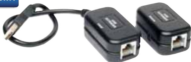
Dispositivo composto da trasmettitore e ricevitore, da collegare tramite cavo patch di rete cat. 5e (o superiore) lungo fino a 60m, amplificando così il segnale USB all'ingresso del trasmettitore (il ricevitore invece riconvertirà il segnale in USB in uscita). Consente l'uso in remoto di stampanti, scanner, tastiere, mouse, video camere etc.
