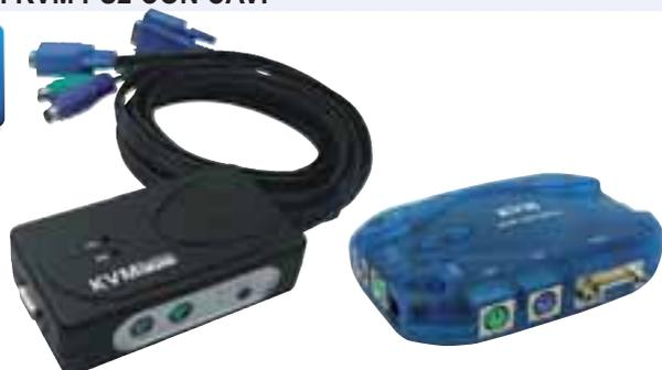
Lo switch KVM PS2 consente di controllare (e selezionare) più PC, con una tastiera (Keyboard), un monitor (VGA) e un Mouse. Cavi inclusi.
