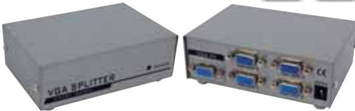
Consente la visualizzazione contemporanea su 4 monitor con ingresso VGA della stessa immagine proveniente da una scheda video VGA di PC o Notebook. Supporta cavi in uscita fino a 65m e risoluzioni fino a 1920x1440. Alimentatore 5Vcc incluso.
