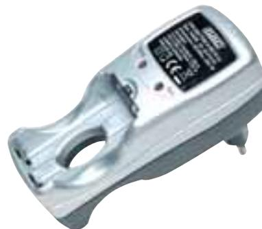
Caricabatterie GBC V-6833B. Sistema di blocco per la ricarica del formato AA (stilo) o AAA (ministilo) con predisposizione automatica della corrente di carica. Con batteria scarica e caricabatteria inserito nella presa il Led rosso rimane acceso fino a che la batteria non risulta carica. Dopo il Led si spegne. Il caricabatteria può caricare solo batterie del medesimo formato e tipo, in coppia e non singolarmente.
