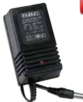
Caricabatterie GBC per ogni tipo di pacco batterie ricaricabili. Adatto per modellismo con indicatore LED di ricarica. Tensione uscita: 4,8 Vcc 330 mA, 9,6 Vcc 100mA. Alimentazione 220Vca. Cavo di collegamento con connettore Plug ø5,5x2,5mm con positivo centrale.
