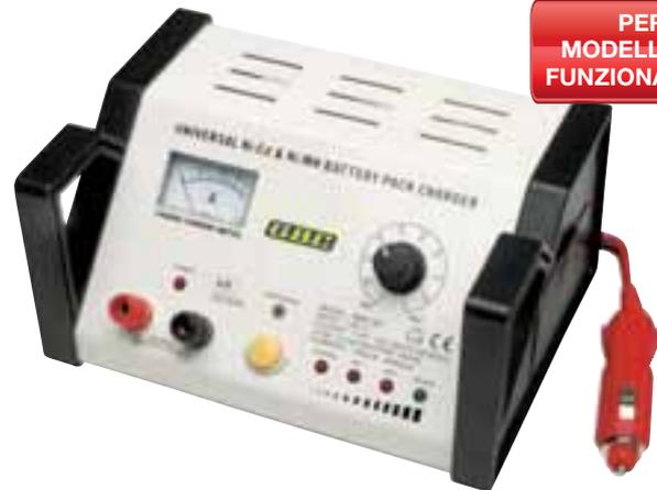
Caricabatterie veloce ed automatico adatto per l'applicazione modellismo. Può caricare da 1 a 10 elementi con una corrente di carica regolabile da 100mA a 4A. Dotato di controllo di fine carica per mezzo di DeltaV, timer di sicurezza e in alternativa controllo temperatura. Mantenimento della carica ad impulsi. Dotato di Led di carica. Protezione cortocircuito, polarità invertita e sovraccarico. Funziona anche come scaricatore.
