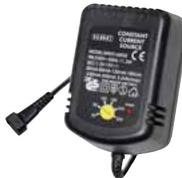
Ideale per pacchi batteria utilizzati ad esempio per modellismo, in bilance, giocattoli e apparecchi elettromedicali. La tensione di carica si autoregola automaticamente mentre la corrente di carica deve essere selezionata tramite cursore. Dotato di led indicatore di ricarica e protetto contro cortocircuiti, sovraccarichi e inversioni di polarità.
